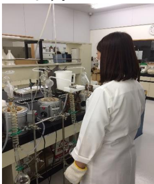
保存料検査：水蒸気蒸留による抽出
