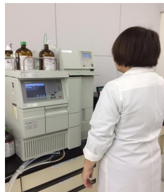
保存料検査：HPLCによる測定
