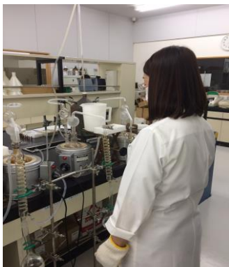
保存料検査：水蒸気蒸留による抽出
