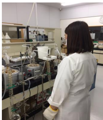
保存料検査：水蒸気蒸留による抽出
