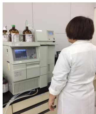
保存料検査：HPLCによる測定
